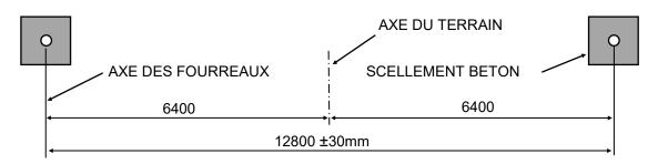
NB: L'ensemble des côtes est exprimé en millimètre
