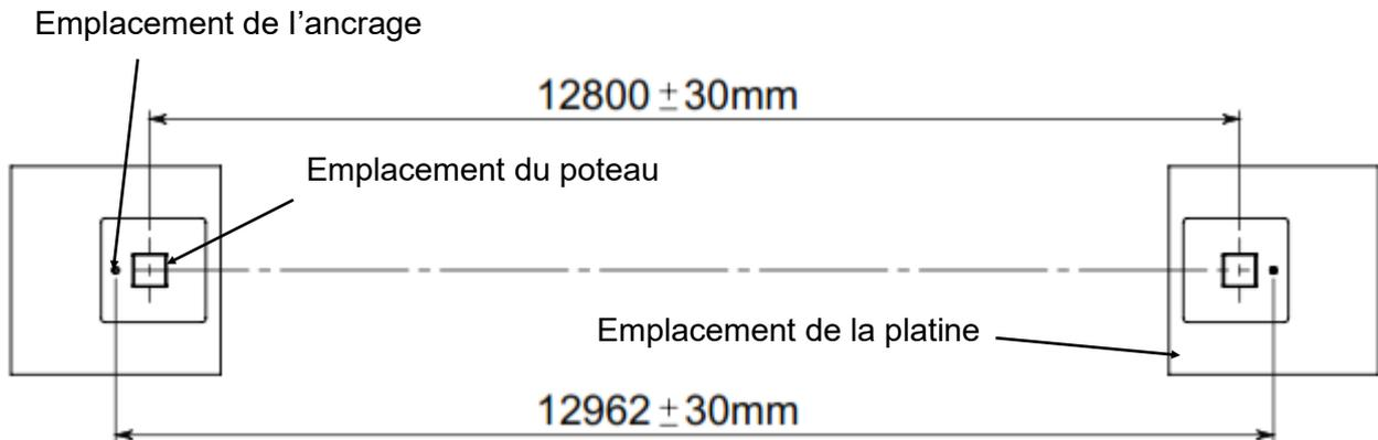
NB: L'ensemble des côtes est exprimé en millimètre
